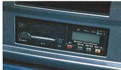
全車両に標準装備しているデジタルタコグラフ。エコドライブならびに安全運転指導が可能。
