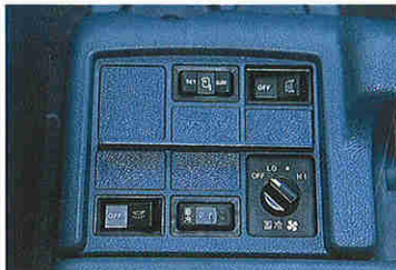
エンジン停止後も運転席に冷風を送ることができる蓄冷式リアクーラー。ドライバーに快適な室内環境を提供する。
