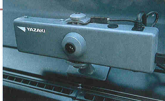
衝撃を感知した際の映像をメモリーカードに記録するドライブレコーダー。ドライバーの安全運転意識向上に役立っている。
