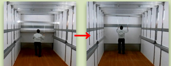
①操作レバーにフック棒2本を引掛ける
