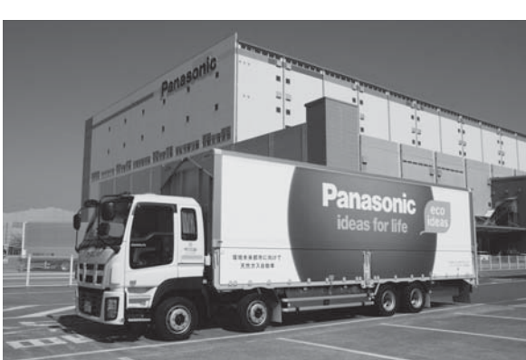
パナソニックが2010年に導入したポスト新長期規制をクリアした大型天然ガストラック
