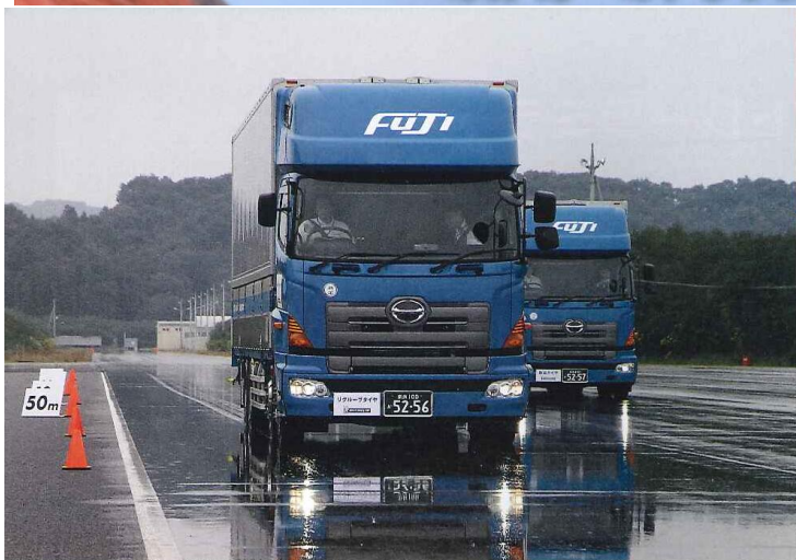
転がり抵抗を比較するフリーローリングテストでは、リグルーブタイヤのほうが新品タイヤより転がり抵抗が少ないことを立証した
