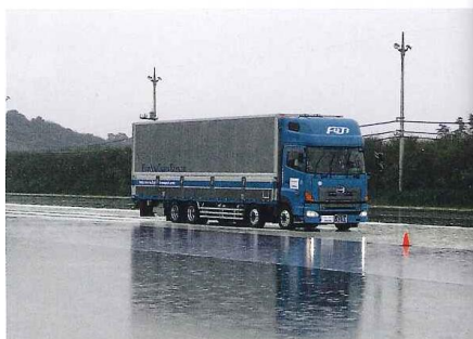
ウェットグリップテストでは、摩耗したタイヤの停止位置（赤いコーン）より、リグルーブタイヤのほうが平均で3.53m停止位置が短いことを示し安全性も訴求した
