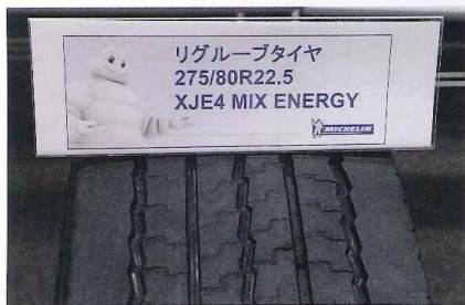
リグルーブタイヤは、摩耗したタイヤに溝切りをしたタイヤのこと。もちろん、専用のリグルーブタイヤであることが大前提だ
