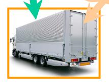
空気の整流効果を高める 傾斜付後門枠採用
