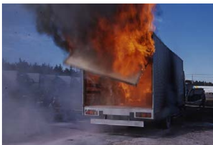
ボデーを全焼させ、火災が積荷に与える影響を調査。万一に備え、富里消防本部の日野デュトロ消防ポンプ車が後方で待機。
